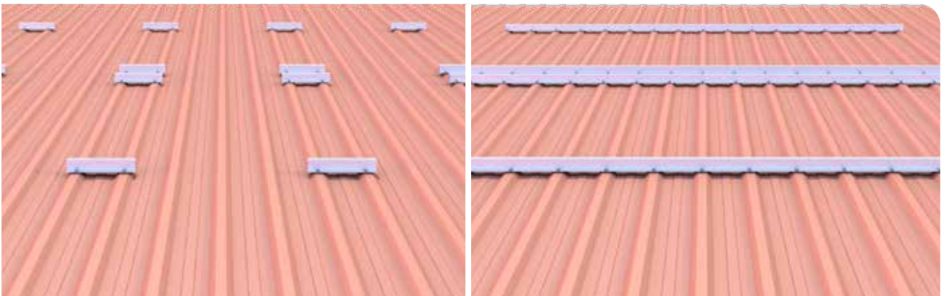
Schritt 2: Befestigen Sie das Montageprofil Trapezblech entweder als durchgehendes Element oder als kurze Einzelstücke.
