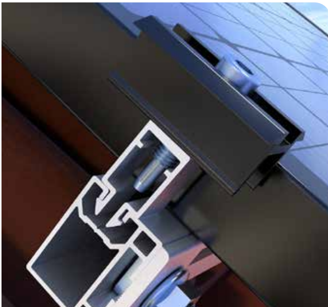
Schritt 3: Das gerade aufstellen der Klemme lässt den zweiten Haken in das Profil einklicken.
