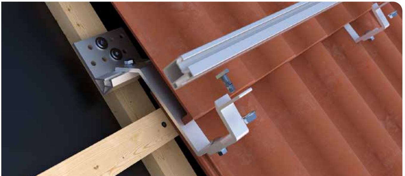
Dachhaken FLEX SLIM an der Konterlatte montiert, durch die ausgeklinkte Dachpfanne geführt und mit montiertem Montageprofil Steildach Slim befestigt.
