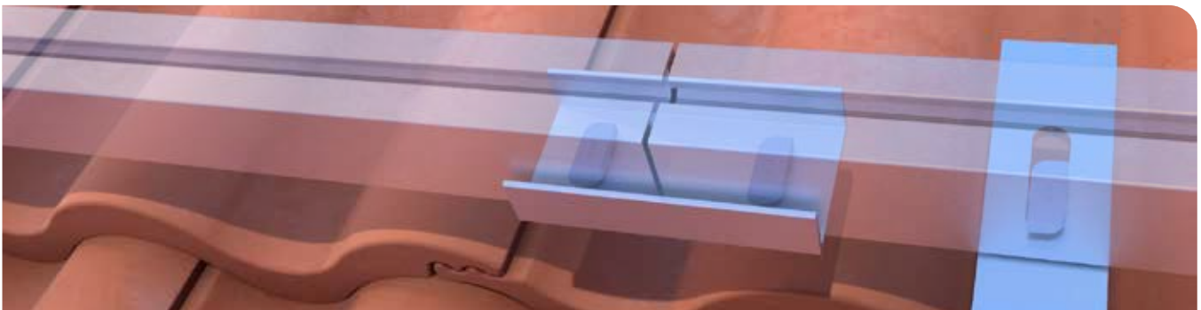
Verbindung von zwei Montageprofilen mittels des U-Profilverbinders.
